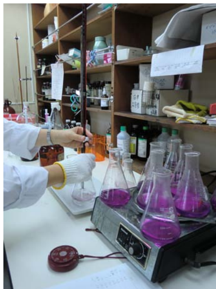
有機物等の検査 (過マンガン酸消費量の滴定)
